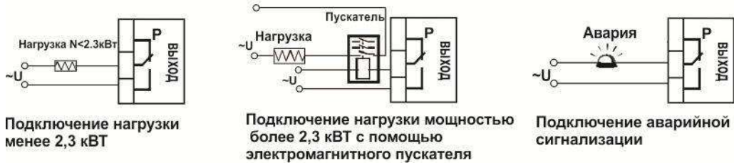
Рисунок 11 – Схемы подключения релейных выходов.
