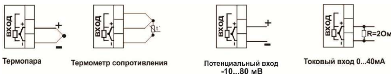
Рисунок 10 – Схема подключения датчиков температуры
