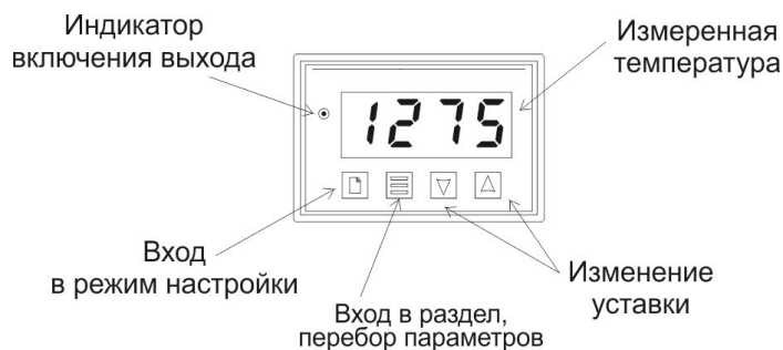
Рисунок 7 – Описание индикаторов и кнопок управления прибора 10М7 - Р4
