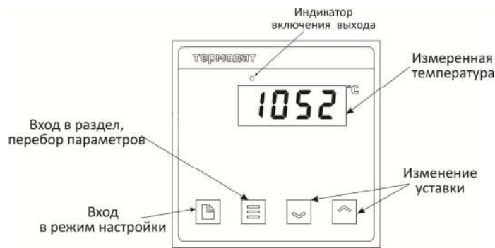
Рисунок 6 – Описание индикаторов и кнопок управления прибора 10М7-М
