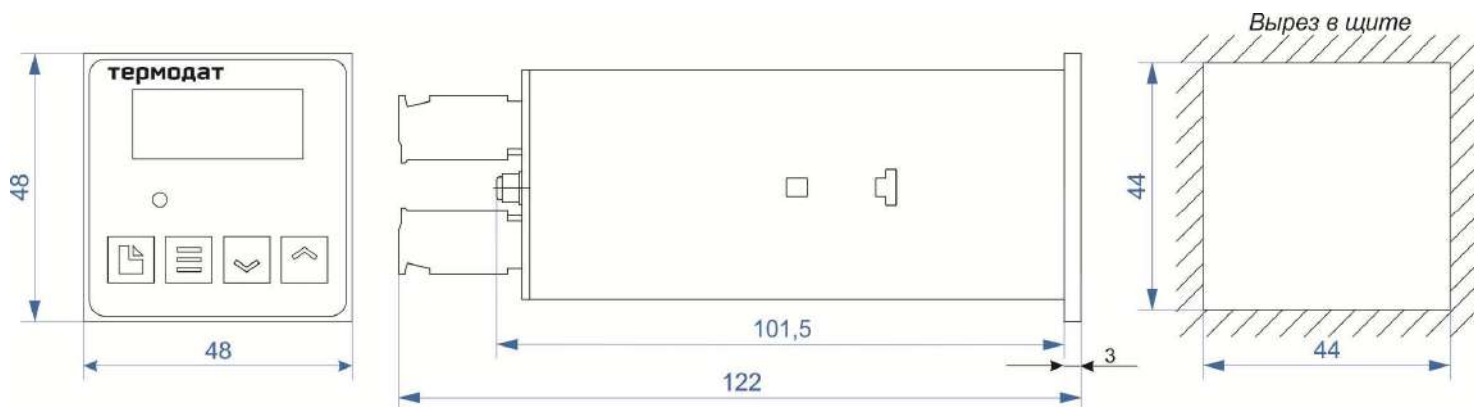
Рисунок 22 – Габаритные размеры прибора 10M7-M
