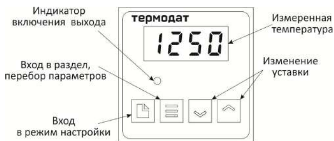
Рисунок 8 – Описание индикаторов и кнопок управления прибора 10М7-К
